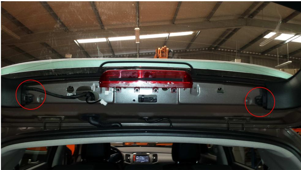
Als letztes die 2 rot markierten und die 2 Schrauben welche unter den zuvor demontierten Teilen sichtbar werden entfernen und das untere Verkleidungsteil entfernen (auch das ist wieder mit mehreren Klipsen zusätzlich befestigt).
