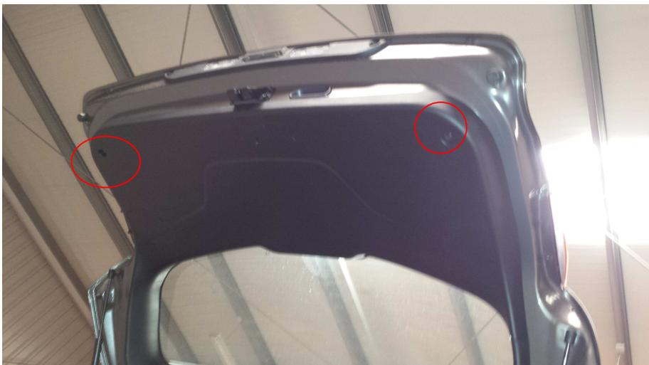
Als nächstes die Rückleuchten aus der Heckklappe entfernen.....diese sind außen mit 2 schwarzen Hutmuttern (10er Nuss) und innen mit 2 normalen Muttern (10er Nuss) befestigt. Stecker aus den Rückleuchten ausklinken!
