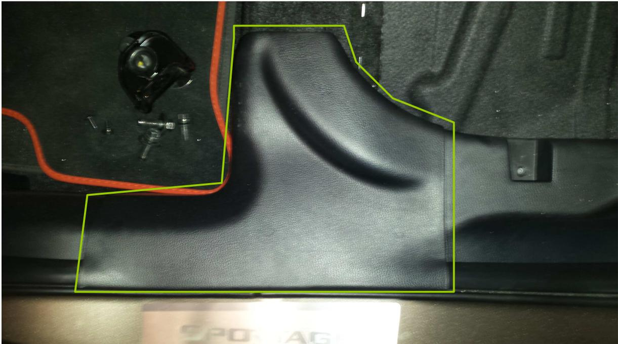
Jetzt an der linken hinteren Tür die grün markierte Verkleidung abziehen( diese ist nur geklipst).....einfach darunterfassen und kräftig ziehen!
