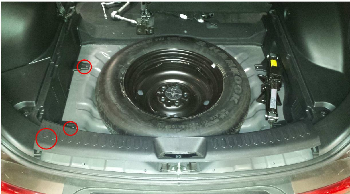
An den rot markierten Stellen sind auch noch Schrauben welche vom Kofferraum aus entfernt werden müssen.
