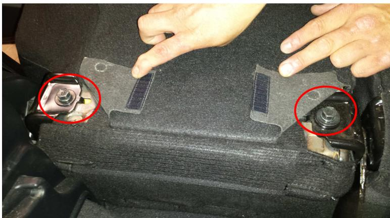
Rückenlehne aus dem Fahrzeug entfernen.
