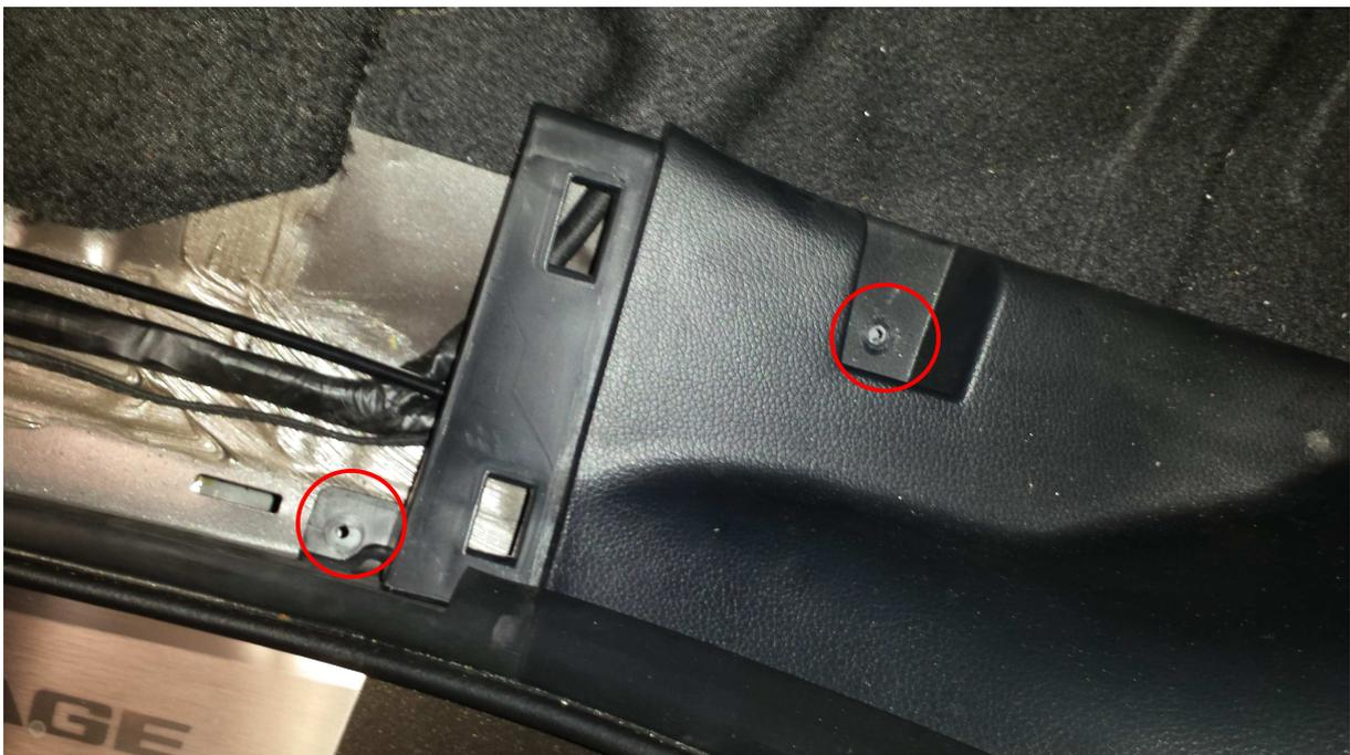
Und noch zwei Schrauben (rot markiert) die entfernt werden müssen.
