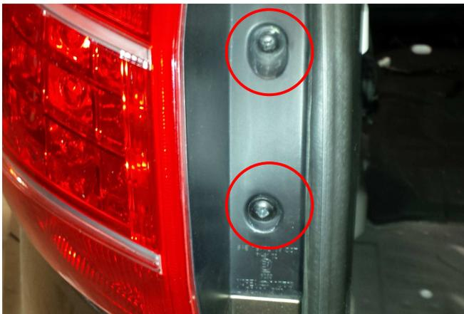
2 Schrauben (von hinten sichtbar) lösen und anschließend die Leuchten mit etwas Druck aber gefühlvoll in Richtung Fahrzeugheck abziehen. Stecker an den Leuchten lösen und die alten Leuchten entfernen.
