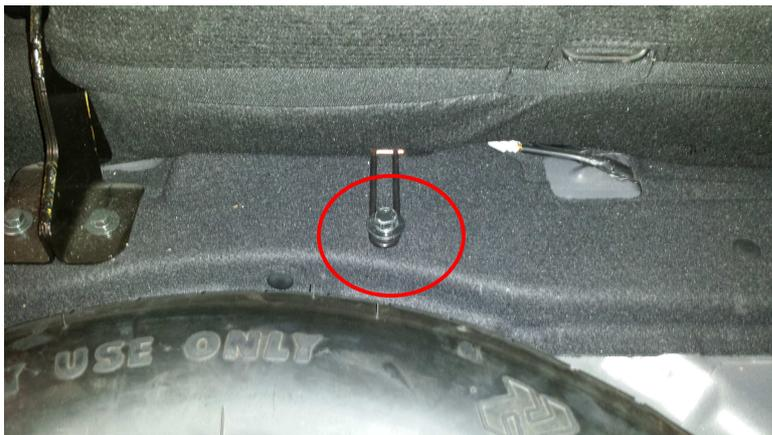
Wenn die Schraube raus ist wird die Sitzfläche an den vorderen Ecken rechts und links aus der Halterung mit einem leichten Ruck nach oben gelöst.....nun die Sitzfläche ca 15 – 20 cm nach vorne ziehen bis die Lasche welche unter der Sicherungsschraube war frei liegt. Sitzfläche nun vorsichtig von hinten nach vorn ankippen und die beiden Stecker der Sitzheizung lösen und danach Sitzfläche aus dem Auto entfernen.
