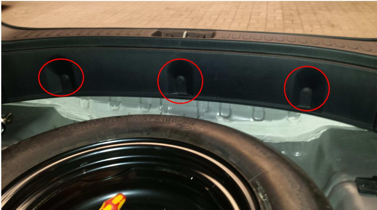
Jetzt kann die Kofferraumkante durch einen kräftigen Ruck nach oben entfernt werden (auch hier sind wieder die Klipse verbaut welche schon die Verkleidung der Heckklappe zusätzlich gehalten haben)
