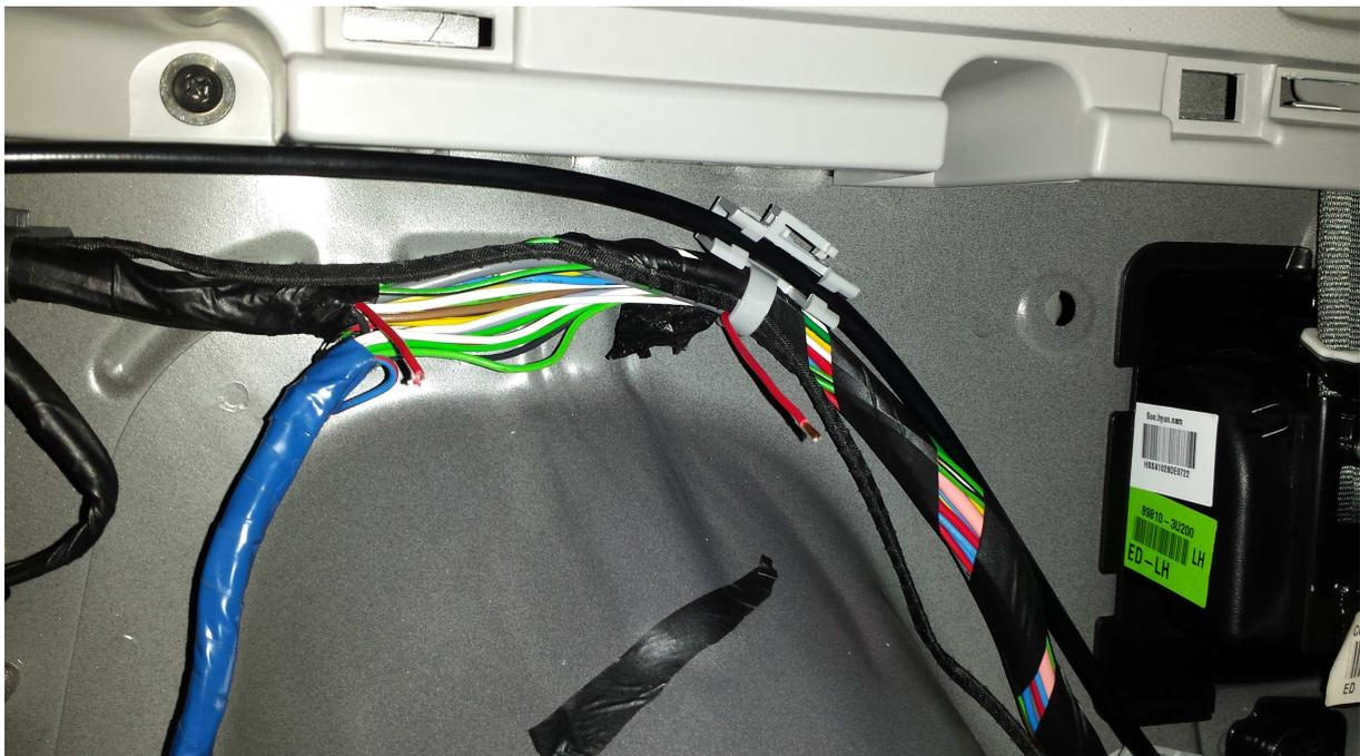
Auf dem oberen Bild ist die **rote Leitung** welche das Signal vom Rückwärtsgang zu den „alten Rückfahrscheinwerfern“ bringt schon aufgetrennt.
