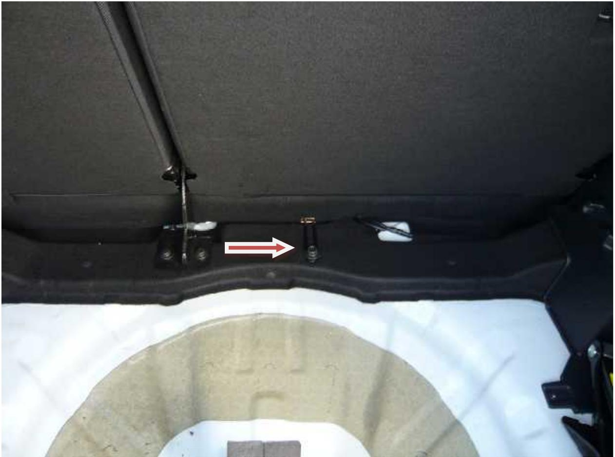
Anschließend die Rücksitzbank aushebeln. Diese ist nicht weiter verschraubt, sondern nur „geclipst“. Einfach von unten nach oben ziehen. Stecker von evtl. vorhandener Sitzheizung abziehen. Rückbank aus dem Auto nehmen.
