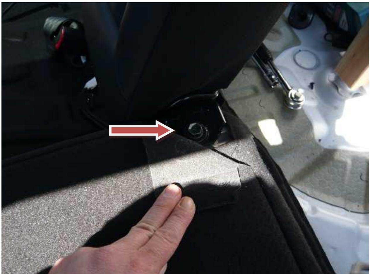
Dann die **rechte** (Fahrerseite) Rücklehnenhalterung (zwei Schrauben) abmontieren.
