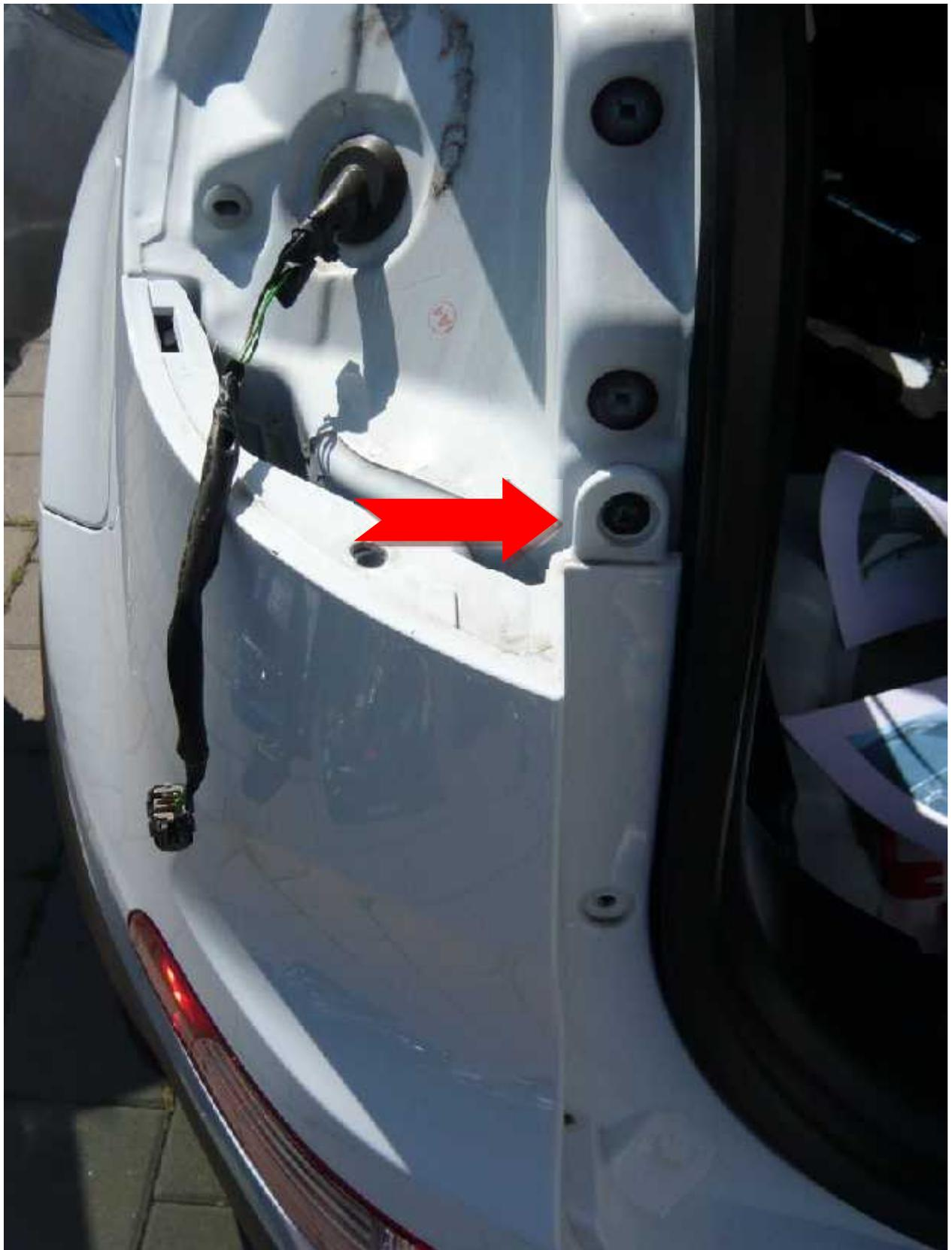
Als nächstes im Innenraum vom linker Kunststoffverkleidung Schrauben entfernen.
