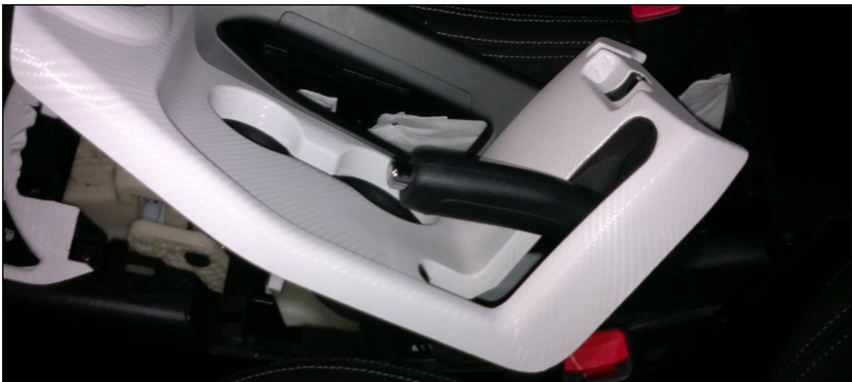
Jetzt die Mittelkonsole vorsichtig aus Schalthebel und Handbremshebel ausfädeln.
