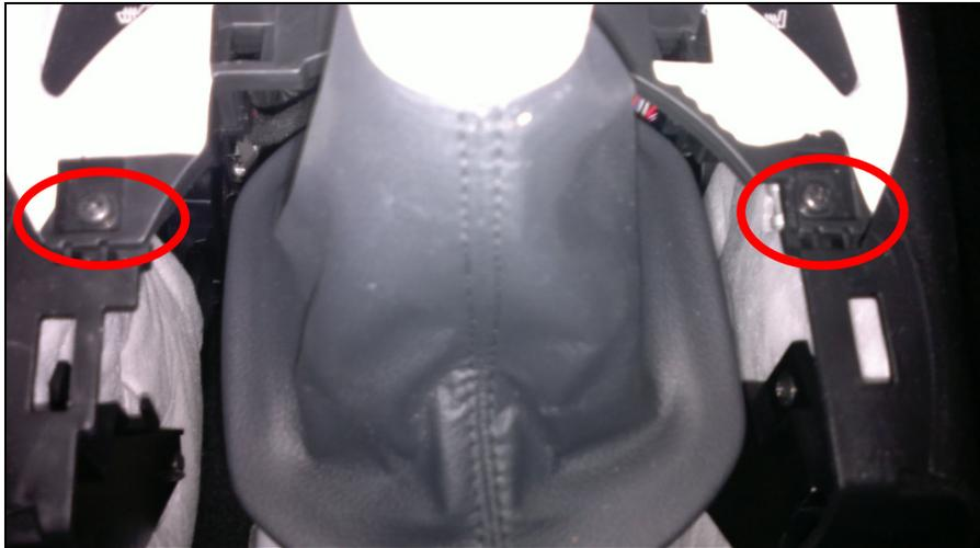
und anschließend das vordere Teil an der Seite des Schalthebels ca. 10cm anheben und vorsichtig die beiden gekennzeichneten Stecker abziehen. Jetzt kann das Teil entfernt werden.
