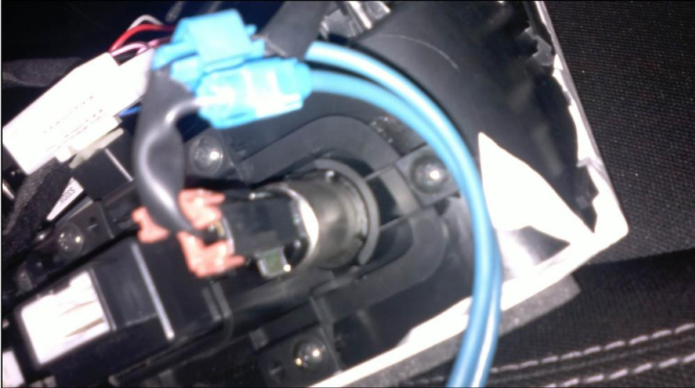
Zur Sicherheit jetzt noch einmal mit einem Messgerät (Durchgangsprüfer) prüfen ob die Kabel auch richtig angeschlossen sind.
