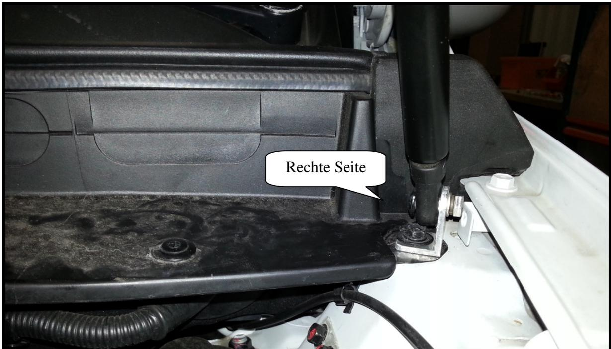
Nun die Motorhaube einmal langsam nach unten ziehen bis sie kurz vorm vollständigen schließen ist und anschließend wieder öffnen. Dadurch justieren sich die Winkel fast automatisch so das sie nun festgeschraubt werden können. Jetzt noch einmal versuchen die Haube zu schließen, dabei genau auf die Winkel achten. Sollten die Dämpferbefestigungen an den Winkeln schleifen diese noch einmal nach justieren.
