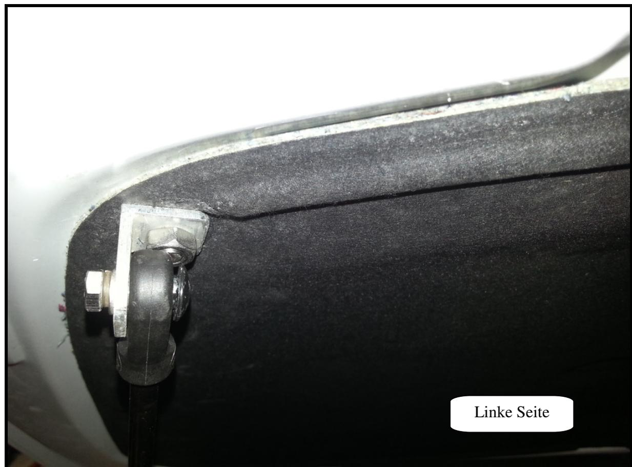
Nun müssen die Gasdruckdämpfer auch an den unteren Winkeln befestigt werden. Dazu empfiehlt es sich eine zweite Person hinzuzuziehen welche die Motorhaube hält bis die Gasdruckdämpfer auch mit den unteren Winkeln verschraubt sind.
