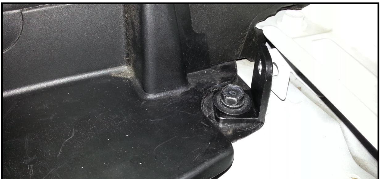
Nun die beiden Gasdruckfedern in an den Winkeln der Motorhaube mit den M6 Schrauben befestigen. siehe Bild!
