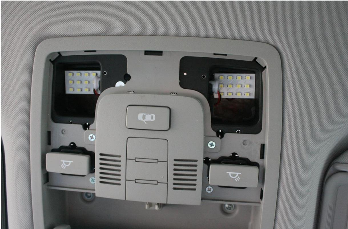
Die Panels hinter den Stecker kleben. Hierfür ist das Panel genau passend! Rechts und links gibt es zwei kleine „Stege“, wo das Panel perfekt aufgeklebt werden kann.
