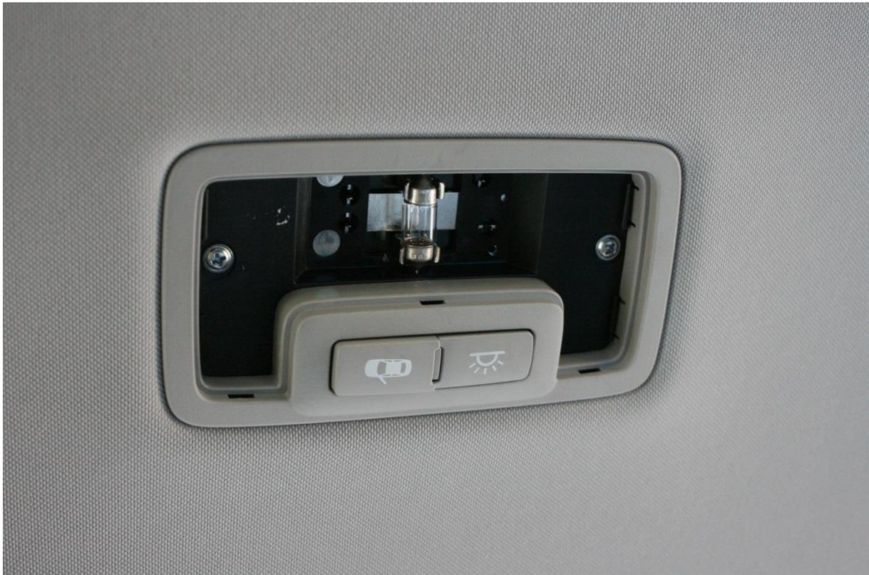
Ein kleiner Nachteil ist, dass wir hier nur eine Stromabnahme haben. Und wenn 2 Panels verbaut werden sollen, dann muss das eine Panel an das andere gelötet werden. Ist aber ganz einfach. 2 Stk. Litzen von ca. 15 cm (das vorhandene Kabel an dem Panel ist zu kurz!) und diese dann auf das Panel mit der Stromversorgung löten (bitte + an + und – an -) – wenn es verpolt wird, dann leuchtet nachher nur das eine oder das andere!!!
