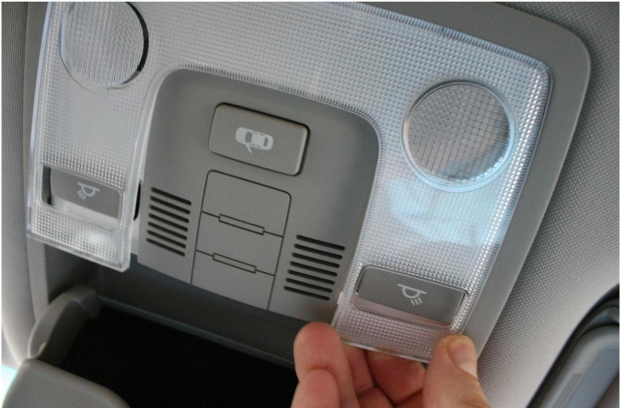
Achtung bei dem Abnehmen der Verkleidung. Direkt dahinter befindet sich ein genauso großer Reflektor. Dieser ist nicht zusätzlich gesichert! Aufpassen, dass der einem nicht gleich entgegen fliegt.
