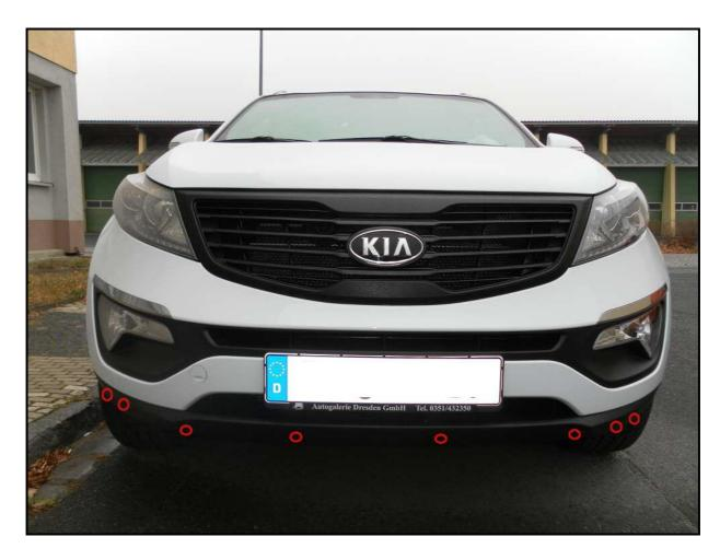
Motorhaube öffnen und die 4 markierten Schrauben herausdrehen. Die rot markierten sind Schrauben mit 10er Kopf die gelb markierten sind wieder Kunststoffspreizer.
