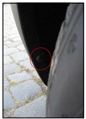
Dann alle 8 Kunststoffspreizer die den Unterfahrschutz mit der Stoßstange verbinden entfernen (rot markiert die ungefähre Lage der Kunststoffspreizer). Merkt euch hier genau wie Stoßstange und Unterfahrschutz verbunden werden....wird beim Zusammenbau sehr hilfreich sein.
