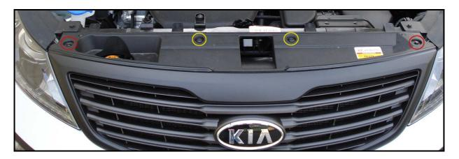
Jetzt die Stoßstange an beiden Seiten aus den Halteklammern herausziehen. Dazu einfach die Stoßstange an der rot markierten Stelle anfassen und nach schräg/vorn ziehen. (Achtung, das geht etwas straff, aber keine Sorge da bricht nichts ab.....kräftig ziehen). Am besten dazu die Handschuhe anziehen! Wenn ihr beide Seiten herausgezogen habt sollte es so aussehen.
