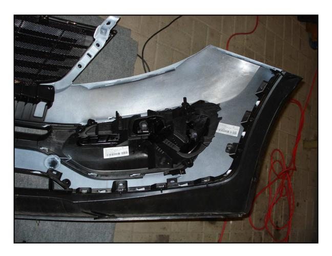
Nun kann man ganz einfach ohne sich die Finger zu verbiegen die Lampen für Nebel- und Abbiegelicht wechseln oder den Grill demontieren bzw. das Gitter hinter den Grill schrauben.
